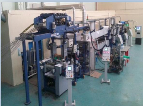
тра углеродных волокон, углеродных и стеклянных тканей с поверхностной плотностью от 60 г/м<sup>2</sup> до 240 г/м<sup>2</sup>. Технологический комплекс позволяет получать препреги методами пропитки клеевыми растворами, нанесения расплавленного состава и ламинирования.
