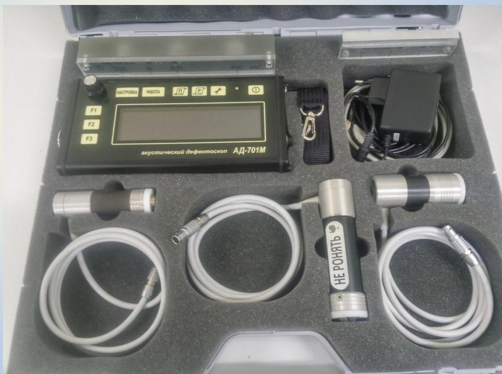
строиться от мешающих факторов. В число дефектов, контролируемых прибором, входят: расслоения, непрочлеи, нарушения сплошности контролируемого объекта.
