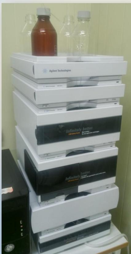
Жидкостной хроматограф Agilent 1200 series включает в себя: систему автоматического ввода проб, систему дегазации растворителей, градиентный бинарный насос, термостат колонок, хроматографическую колонку размером 4,6x150 мм, заполненную октадецилсиликагелем с размером частиц 3,5 мкм (Zorbax Eclipse XDB-C18), с предколонкой с аналогичным сорбентом и УФ-детектор с фотодиодной матрицей.
