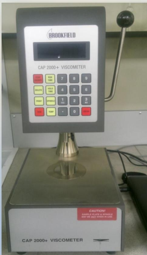
Вискозиметры Брукфильда предназначены для определения вязкости полимерных связующих по принципу ротационной вискозиметрии в диапазоне от 50 до 25000 сПуаз, а также для получения кривых, зависимостей вязкости полимера от температуры при постоянной или переменной скорости нагрева.
