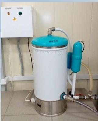
Предназначен для производства дистиллированной воды, отвечающей требованиям действующей Госфармакопеи РФ ФС 42-2619-89, путем тепловой перегонки воды, отвечающей требованиям Сан.ПиН 2.1.4.559.
