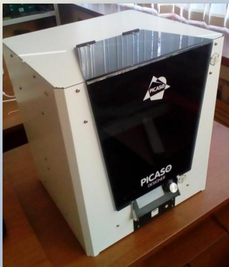
3D принтер предназначен для печати пластиком различного типа объемных деталей и изделий на основе 3D моделей. Минимальная толщина наносимого слоя пластика составляет 50 мкм, что позволяет создавать изделия с достаточно высокой точностью.
