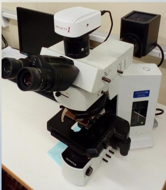
Предназначен для проведения визуальных исследований, требующих высокую четкость и разрешение изображений. Оптическая система данного микроскопа имеет объективы с высокой числовой апертурой (до 1,65), обеспечивающее высокую коррекцию хроматических аберраций и высокое разрешение. Наличие широкого диапазона флуоресцентных фильтр-блоков обеспечивает высокий контраст изображения и устраняет 99% постороннего фонового излучения.
