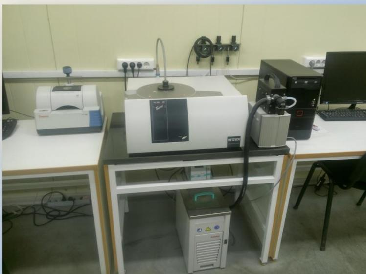
Термомикровесы TG 209 F3 Tarsus представляют собой универсальный современный прибор, используемый как при оценке качества полимерных составов, так и для серийных измерений в различных областях органической химии, фармацевтики,
